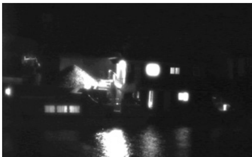
图 6-4 在大雾天气距离摄像机 3 公里船舶的图片
