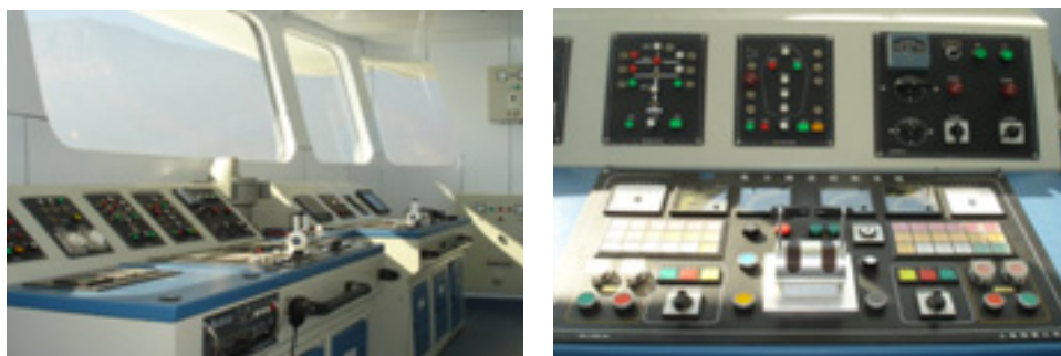
图 4-3 电力推进操纵控制系统
