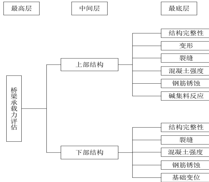
图2 西藏地区在役桥梁承载力评估模型
